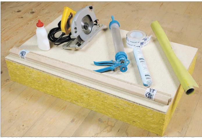
Wenn Sie für die Dämmung des Estrichbodens eine trittfeste Dämmplatte verwenden, ist das Verlegen keine Hexerei. Mit etwas Geschick können Sie die Arbeit auch selber ausführen. Dazu brauchen Sie diese Utensilien: wasserfesten Holz-Kaltleim, Handkreissäge, Silikon, geeignetes Klebeband, Luftdichtigkeitsschicht und Hartholzfedern. (Fotos: Flumroc AG)
